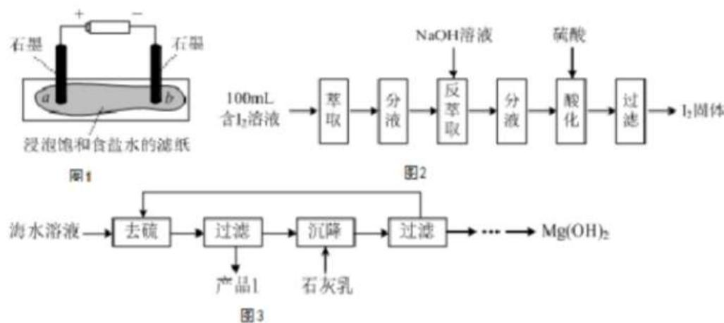
装置如1图所示，接通电源，当观察到石墨电极与滤纸接触的区域有细小的气泡产生时，停止通电。将pH试纸分别放在a、b处滤纸上，观察颜色变化。
